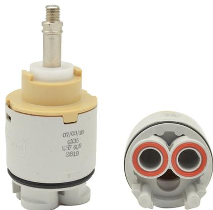
Cartuccia a dischi ceramici per rubinetti monocomando. Con movimento Joystick. Perno filettato con passo M 6. Con distributore. Altezza totale 75 mm.
