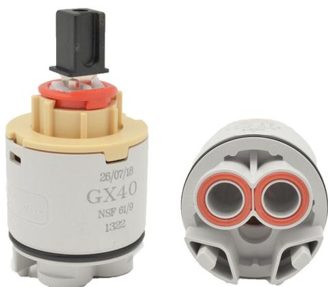
Cartuccia a dischi ceramici per rubinetti monocomando. Asta in ottone con adattatore in plastica, quadro 10 x 10.5. Versione con distributore. Altezza totale 74 mm.
