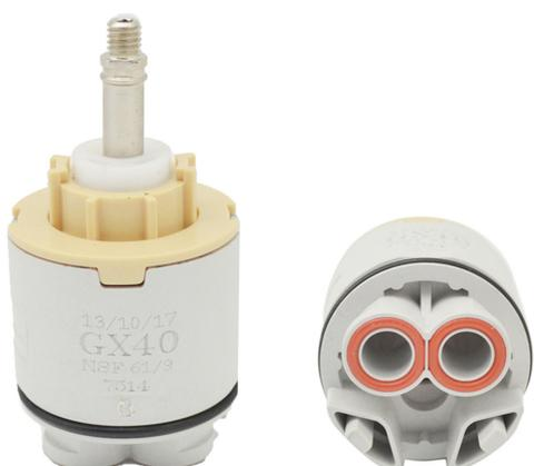
Cartuccia a dischi ceramici per rubinetti monocomando. Con movimento Joystick. Perno filettato con passo M 6. Versione con distributore. Altezza totale 75 mm.
