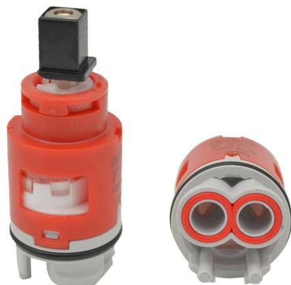
Cartuccia a dischi ceramici per rubinetti monocomando, asta in ottone con adattatore in plastica, quadro 9x9. Versione con distributore. Altezza totale 60 mm
