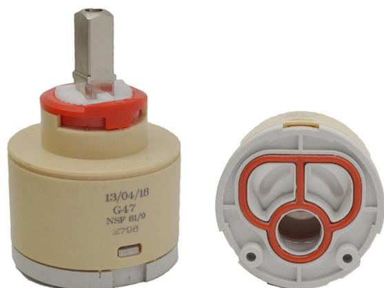
Cartuccia a dischi ceramici per rubinetti monocomando. Asta in ottone con adattatore in plastica, quadro 10x10,5. Altezza totale 62 mm.
