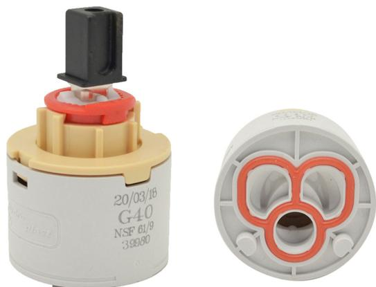
Cartuccia a dischi ceramici per rubinetti monocomando. Asta in ottone con adattatore in plastica, quadro 10 x 10,5. Altezza totale 62 mm.
